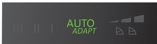
Abb. 13 Leuchtfelder zur Anzeige der Pumpeneinstellung
