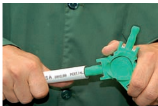
2. Calibrare il tubo con apposito calibratore
