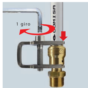
2 Utilizzando la chiave a brugola stringere lo strumento effettuando un giro completo della vite.
