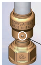
4. Inserire il tubo multistrato fino a quando sarà visibile attraverso il foro di controllo
