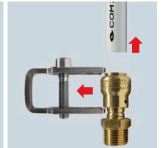
3 Lösen der Verbindung durch Ausziehen des Rohres und entfernen des Werkzeuges. Der Steckfitting ist wiederverwendbar
